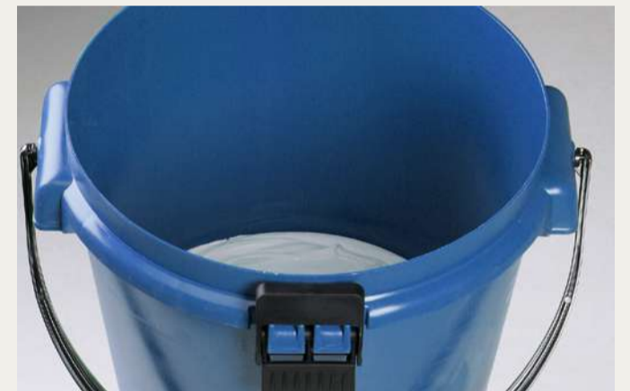
2 Spachteltrichter mit pastöser Spachtelmasse füllen
